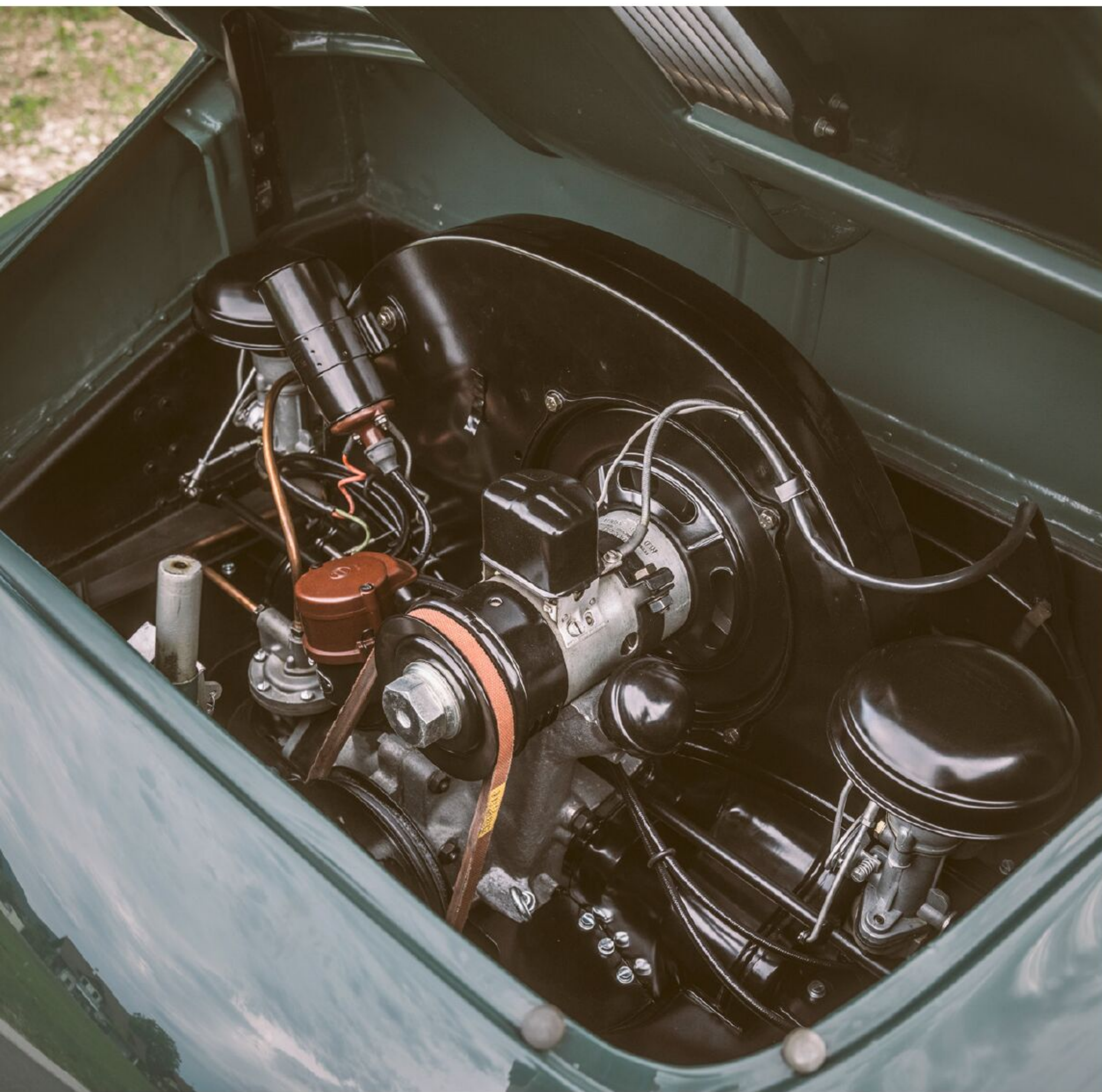
Ein Plus an Leistung: Dank zweier Vergaser und modifizierter Zylinderköpfe holt der VW-Vierzylinder im Heck 40 PS aus 1,1 Litern Hubraum. Vorne bleibt nur Platz für Tank und Ersatzrad (r.).
